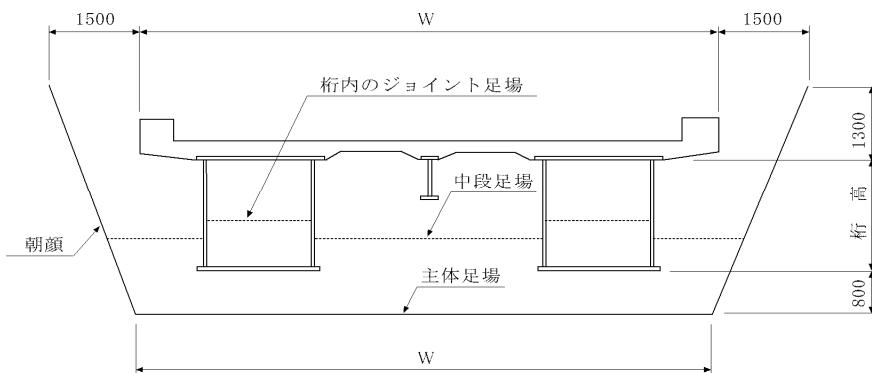
中段足場は桁高が1.5mを超える場合に設置し、桁高が3.3mを超える場合には、(ア)m増すごとに増設することを標準とする。
