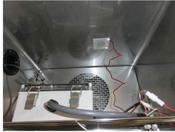
恒温恒湿槽とACMセンサを用いた腐食環境因子の評価
