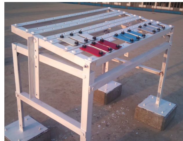
塗膜の大気曝露試験
