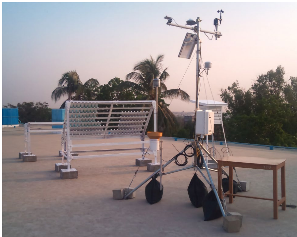
YTU建物屋上での大気曝露試験(2014年3月から)
