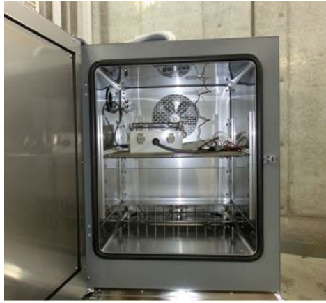
恒温恒湿槽とACMセンサを用いた腐食環境因子の評価
