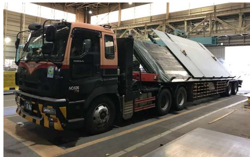
傾斜車両による鋼板の輸送
