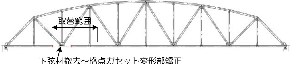
STEP3：斜材側格点部新規下弦材架設
