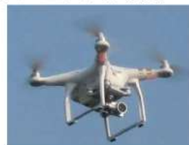
UAV(ドローン等)による3次元測量
