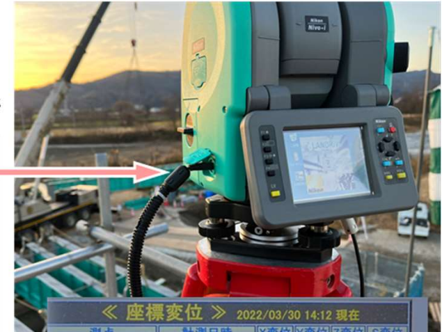
トータルステーションによる桁の出来形計測イメージ
