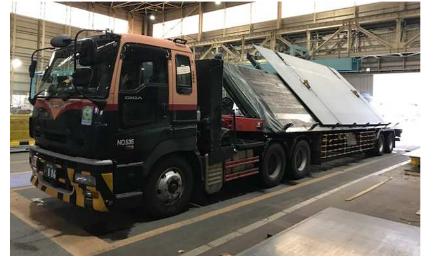
傾動車両による鋼板の輸送
