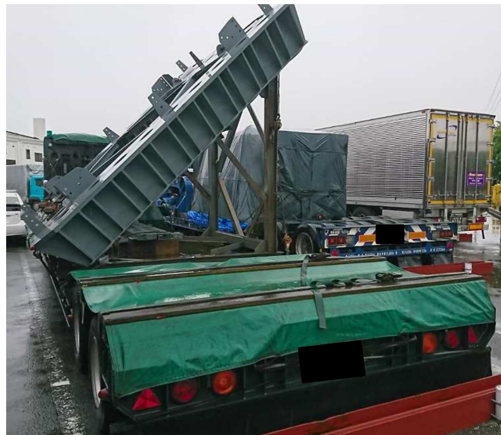
アンカーフレームの積付け
