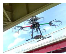
ドローンによる損傷把握
