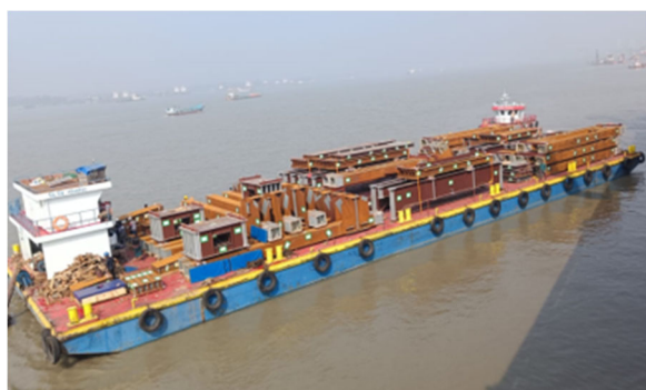
写真 6－2 台船による河川輸送状況
