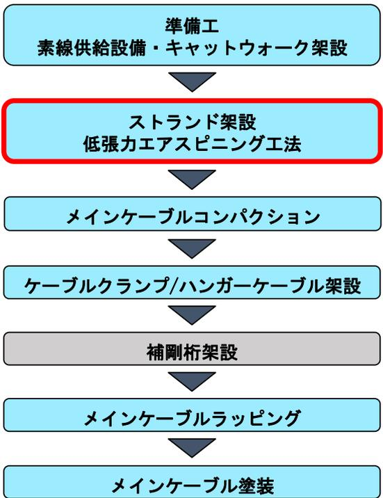
図-3-1 ケーブル架設工程概要
