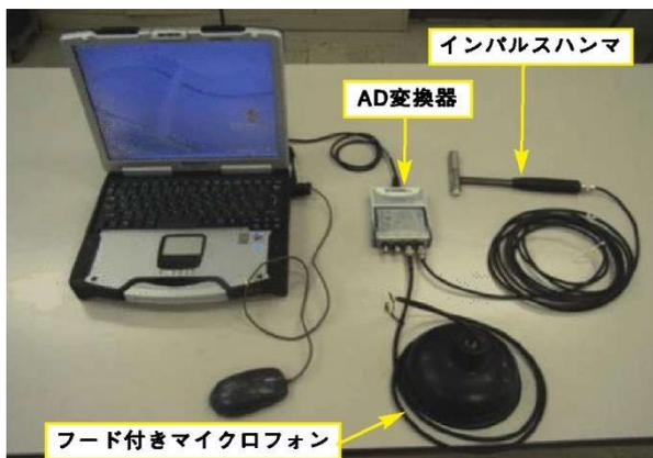
写真-3 打音法（検査装置）
