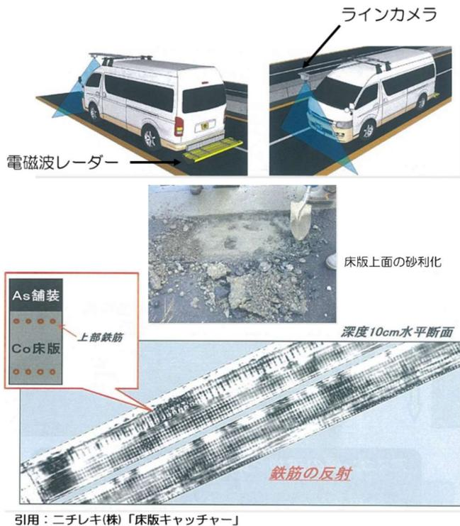
図-16 車載型点検装置
