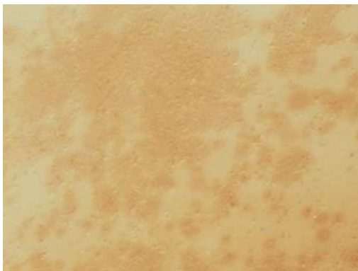
図-16 仕様 D 上フランジ上面の膨れ
