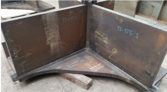
写真4-1 3線交差部モックアップ
