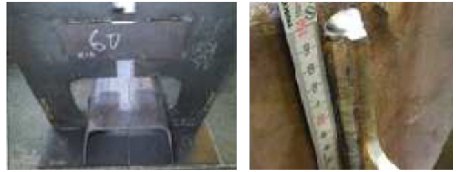
(a) 試験体 (b) まわし溶接部 図-16 改良スリット形状の溶接性確認試験
