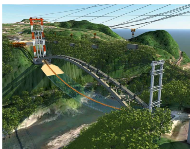
図-7 CIM モデル (架設状況)
