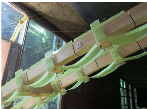
写真14 渦励振対策構造(閉塞率100%)
