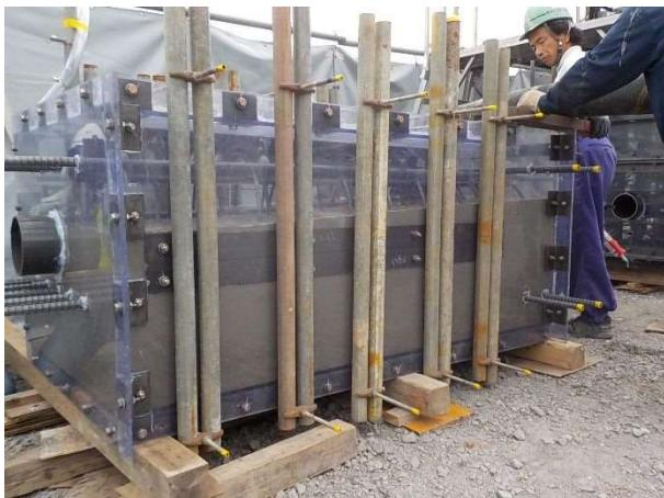
写真8 充填性検証試験の状況
