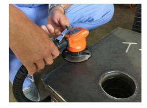
写真-3.3 曲面加工用工具
