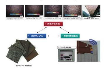
図-3.1 さび外観評価補助システム2)
