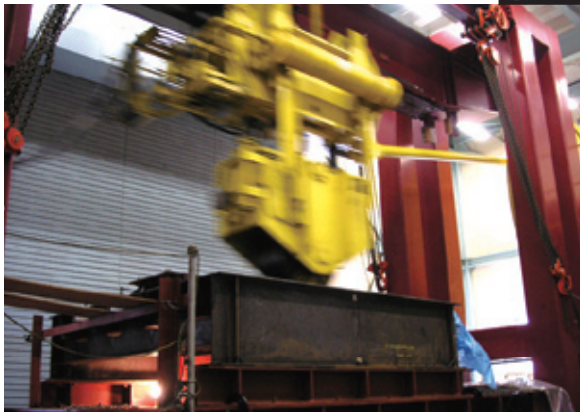
移動輪荷重試験による耐久性試験 (荷重118kN, 300万回載荷)
