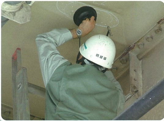
インパルスハンマにて底鋼板を叩いた時の打撃力と、フード付きマイクから採取した打撃音による波形と周波数から空隙や浸水を検知します。
