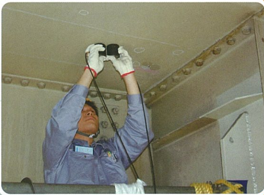
適切な周波数帯域の探触子を用いた超音波信号を処理することにより、はく離箇所を把握します。
