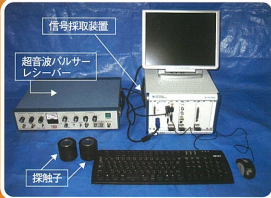
適切な周波数帯域の探触子を用いた超音波信号を処理することにより、はく離箇所を把握します。
