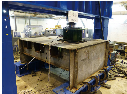
図-5 鋼床版供試体を用いた疲労試験状況
