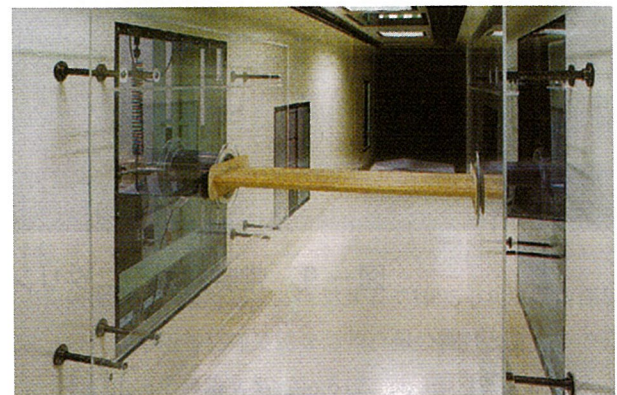
図－7 新設された強風シミュレーション 風洞での橋桁の耐風性実験
