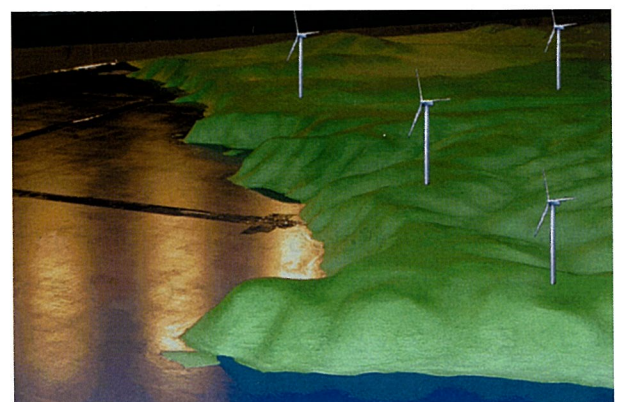
図－8 地形模型型実験による風力発電量の予測
