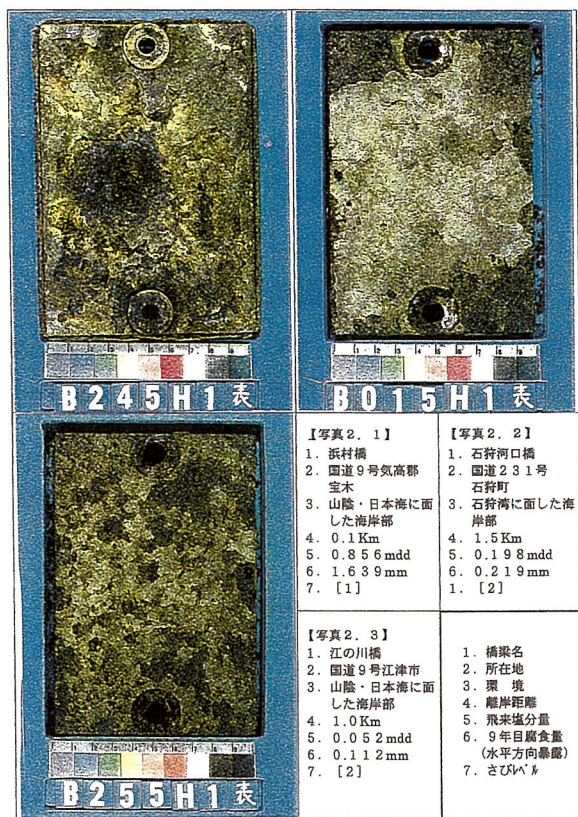
写真2. 1～3 代表的なさびレベル (三者共研41橋調査結果より)
