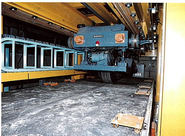
写真2 輪荷重走行疲労試験機
