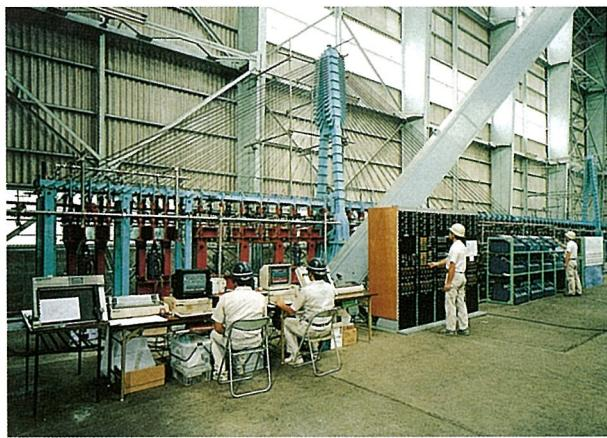
写真-5 多々羅大橋1/50全橋模型の座屈試験
