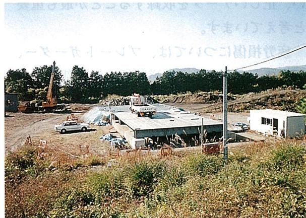
写真-6 合理化鋼床版の載荷試験
