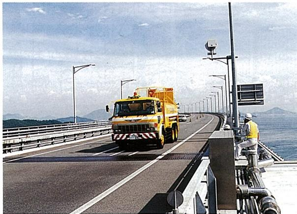
写真-2 荷重車の走行試験
