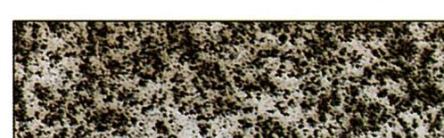
図-2 デトロイトの橋梁のさびセロテープ
