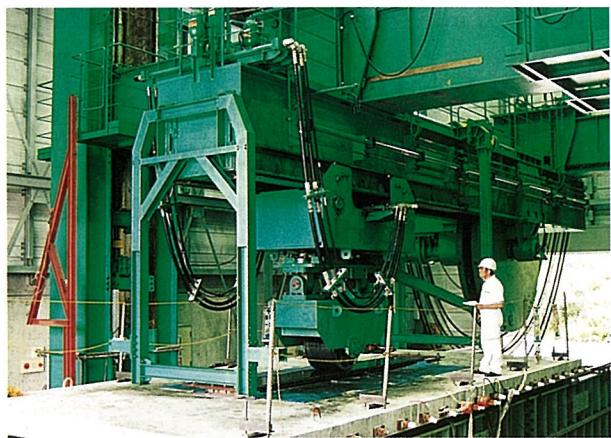
写真-4 PC床版の移動載荷疲労試験
