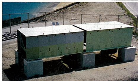
写真-2 新設及び塗替え塗装試験体 (塗替え塗装体の上塗り塗装後)
