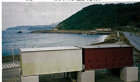
写真-1 新設及び塗替え塗装試験体 (塗替え塗装体のさび止め塗装後)
