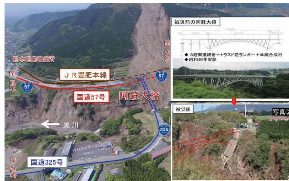
図-2 阿蘇大橋地区の被災状況
