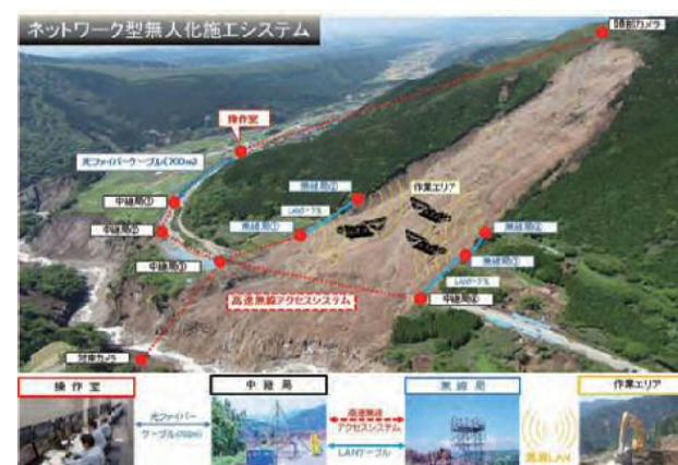
図-3 ネットワーク型無人化施工システム
