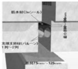
平成26年、コンクリート桁端部における止水技術（3eシール）を開発しました。
