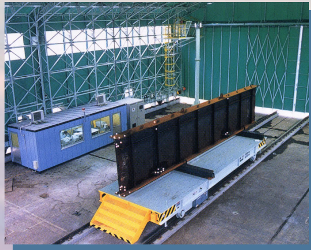
部材計測状況
