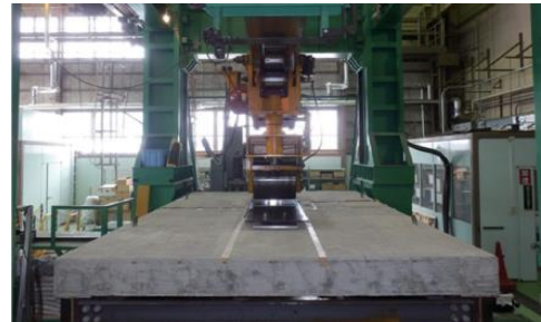
輪荷重走行試験による耐久性の確認
