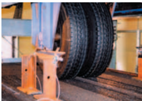
輪荷重移動載荷試験状況
