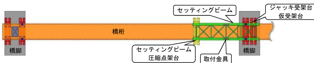
図-2 セッティングビームを使用したサンドル降下事例（平面図）
