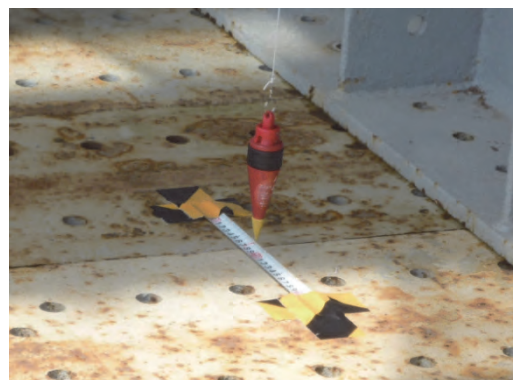
(d) 下げ振りによる計測（詳細）
