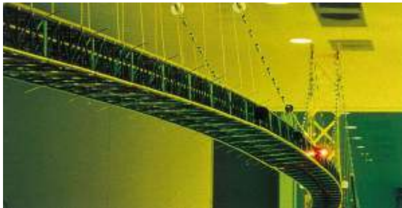
明石海峡大橋1/100全橋模型による 風洞実験
