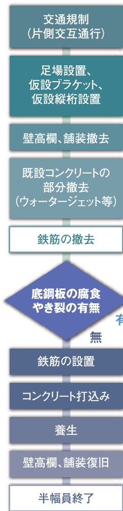
■部分打ち替えの施工フローの例
