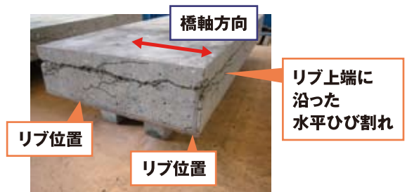
■実験で現れた損傷(水平ひび割れ)
