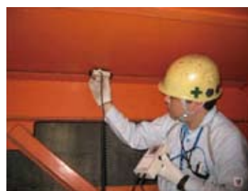
■ 弾性スイープ波法による検査例(※5)
