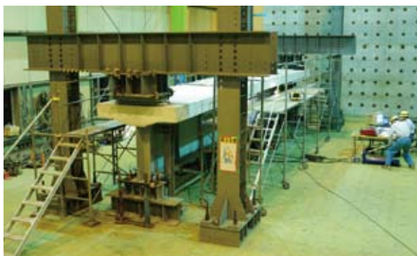
■合成桁の負曲げ実験(※6)
