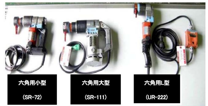
写真-38 六角高力ボルト（HTB）用締付機械
