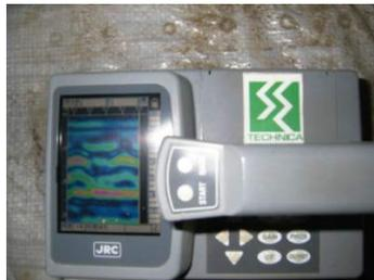
写真-5 鉄筋探査の状況
