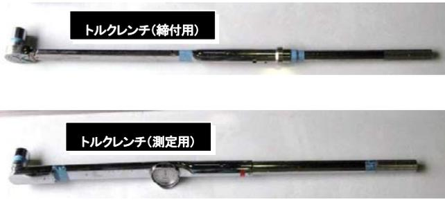
写真-39 六角高力ボルト (HTB) 手締め用工具
