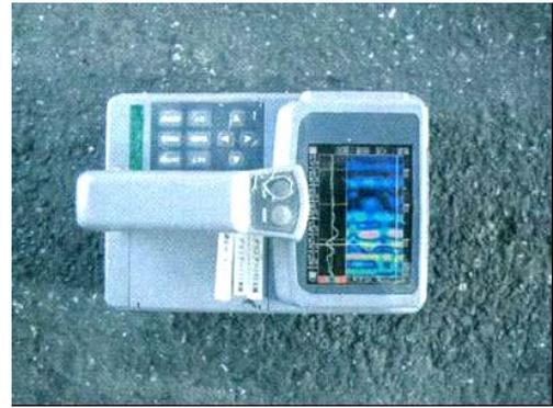
写真-7 電磁波レーダー<sup>4)</sup>
