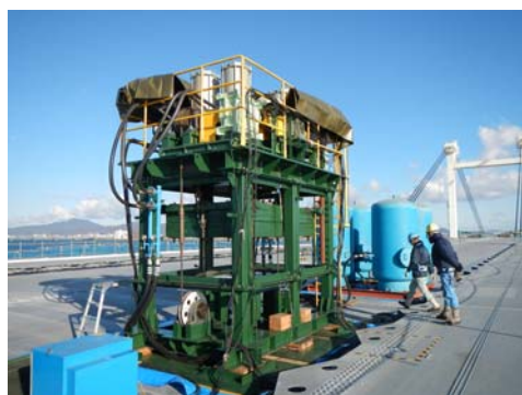
写真－16 大型起振機設
