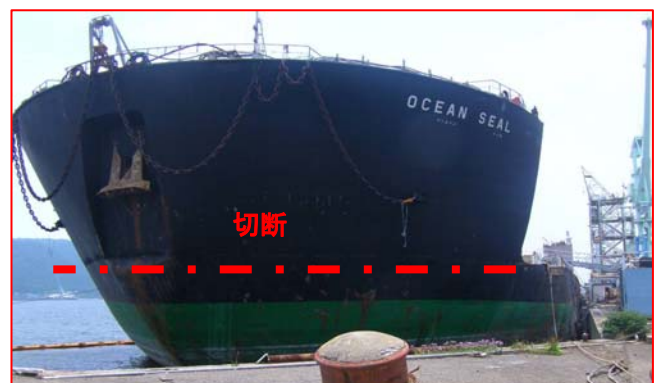
写真-3 台船改造(切断撤去)前
