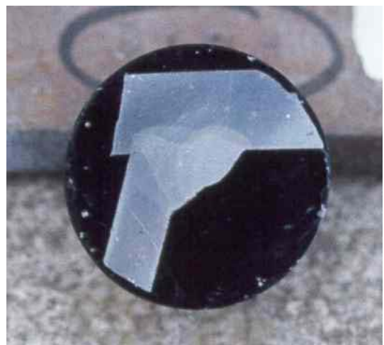
図-33 補修溶接後の溶接断面 14)
