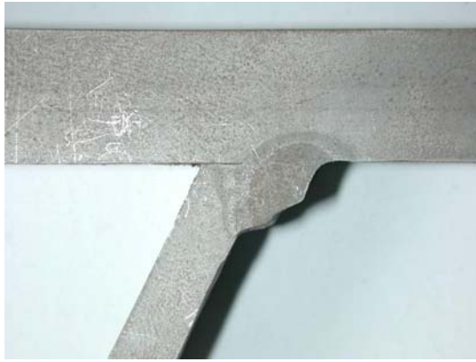
図-14 溶接の溶込み状況 14)
