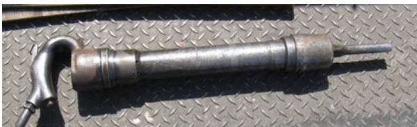
写真-9 リベットバスター (押し抜き用チゼル装着)
