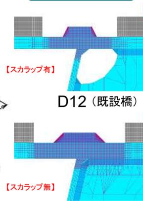
吊金具残し部高さはいずれも10mm
