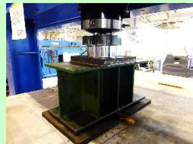
静的載荷試験では、着目部近傍のひずみ分布が解析値と概ね一致することを確認した。
