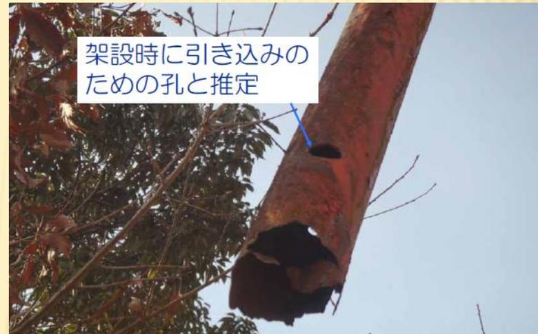
パイプ型ターンバックル(特製品)の孔(20φ)から水が入り内部から腐食。外部からは腐食の進行が確認できなかった。**鋼材を腐食から防ぐ：空気と水を遮断(塗装、メッキ、グラウトなど)すること。**水仕舞いが大切：水は入らないようにする。そして必ず出るようにする。
