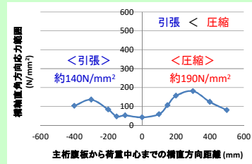
(a) 腹板側止端部
