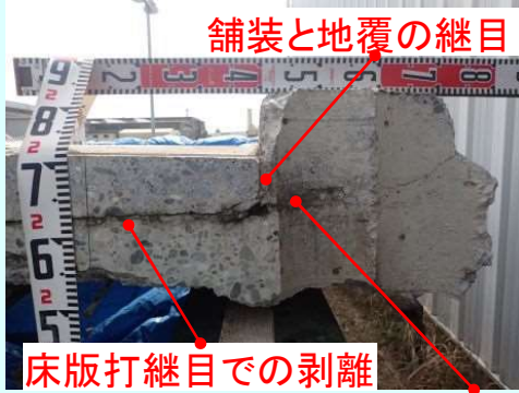
コンクリートの充填不良
