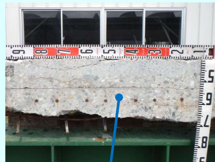
④床版打継目での剥離
