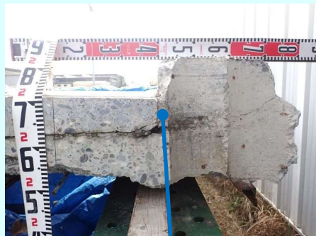
②舗装と地覆の継目(水みち)
