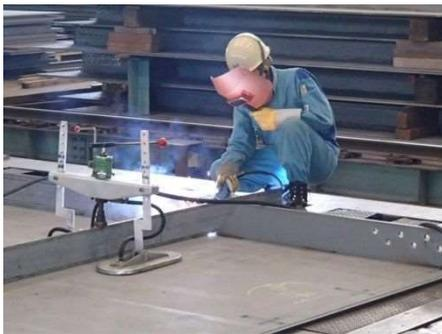
補剛材溶接(多関節CO2溶接ロボット)
