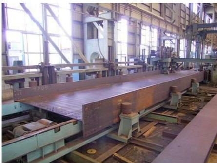
I桁溶接装置(2電極サブマージアーク溶接機)
