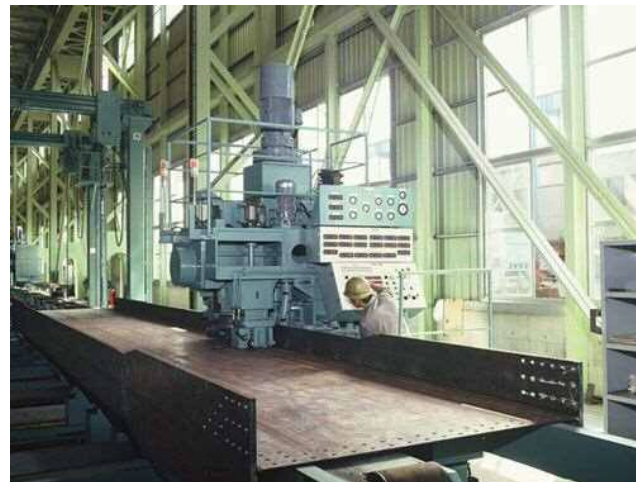
I桁矯正装置
