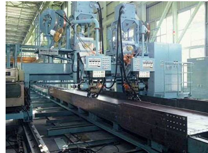
I桁溶接装置(2電極サブマージーク溶接機)
