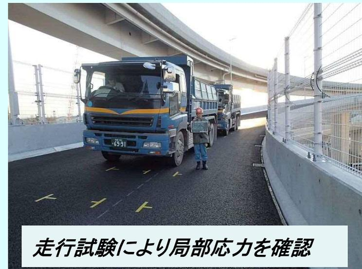
走行試験により局部応力を確認
