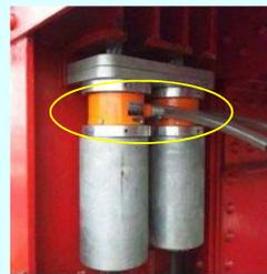
写真2 ロードセル設置(格点41)
