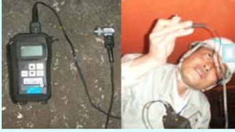
底鋼板の板厚測定
