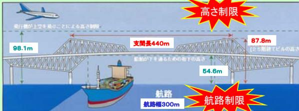
6万t級の大型コンテナ船やクイーンエリザベスII世号も通行可能
