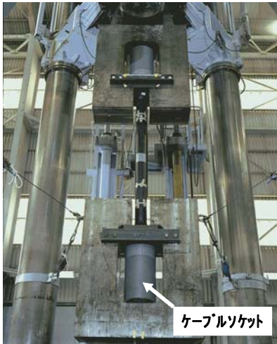
施工技術総合研究所(静岡県) 写真-1 アンカー疲労試験
